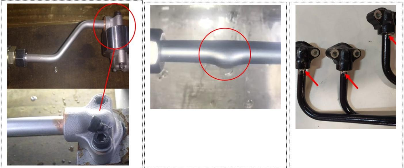
Figura 3. Ensaio destrutivo alta pressão | Detalhe deformação plástica tubo | Produto acabado pós brasagem e pintura
